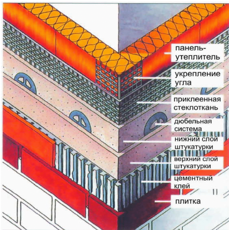
Рис. 2.39. Структура фасадной системы
